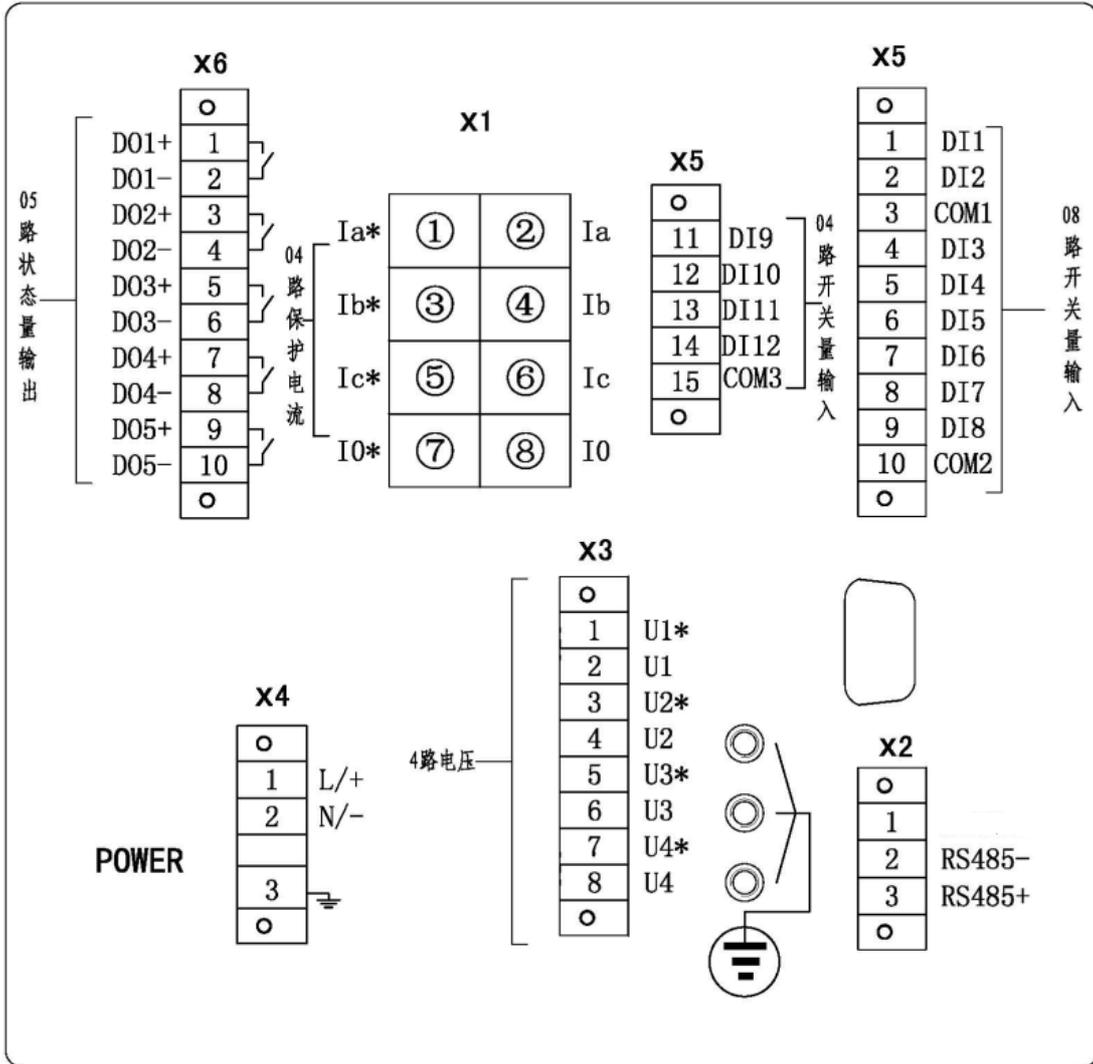
图 1.16 AM4-I 电气接线图
