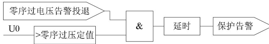
图 1.8 零序过电压告警逻辑
