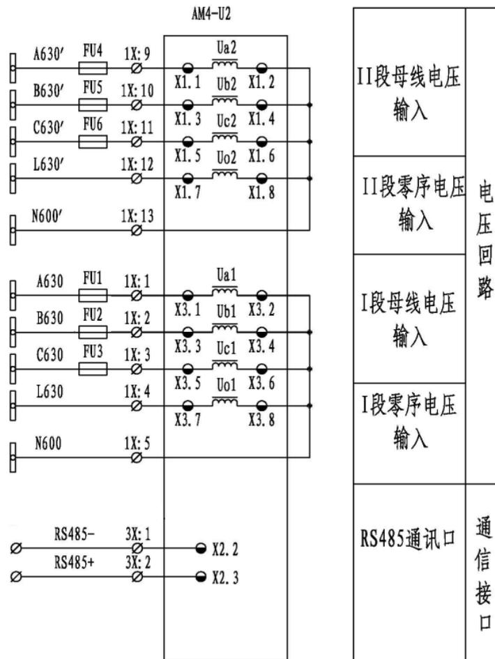
图 3.6 AM4-U2 两段母线电压保护装置二次原理图（一）
