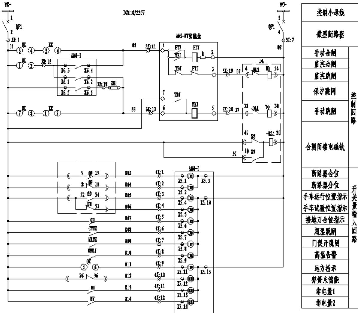
图 1.19 AM4-I 控制回路、开入回路原理图（二）
