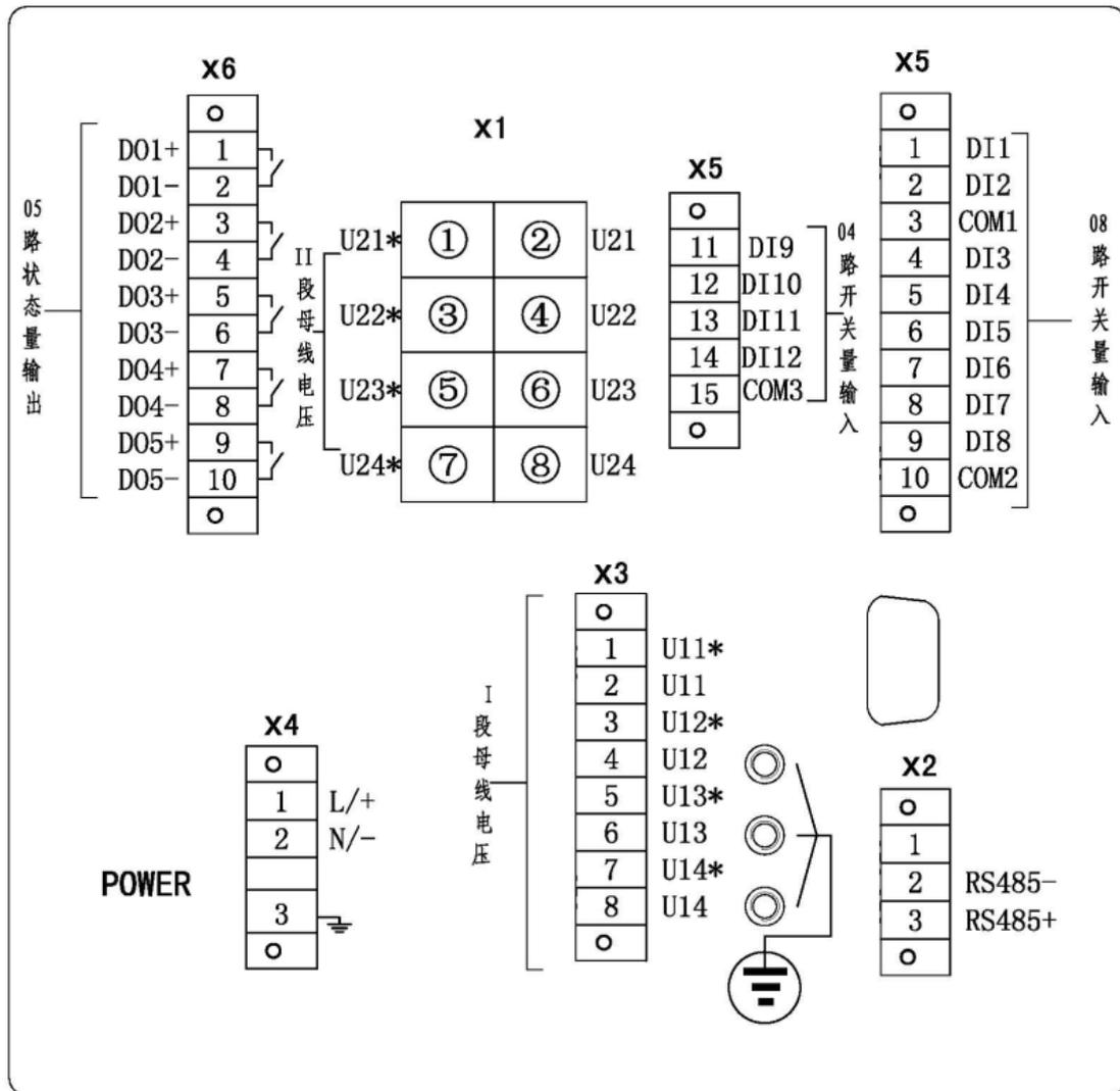
图 3.4 AM4-U2 两段母线电压保护装置电气接线图
