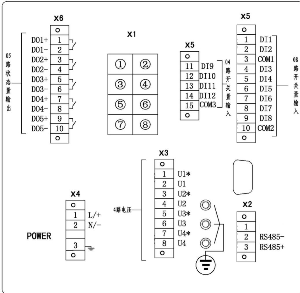
图 2.4 AM4-U1 电气接线图
