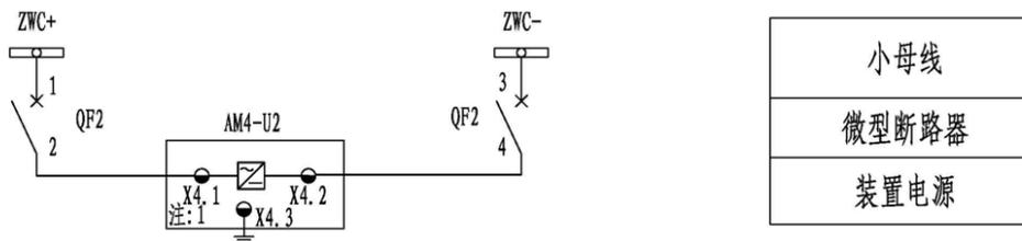
图 3.7 AM4-U2 两段母线电压保护装置二次原理图（二）
