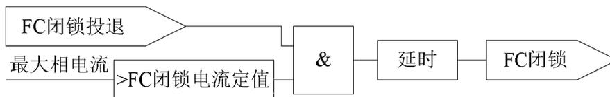
图 1.6 FC 回路配合的过流闭锁功能逻辑
