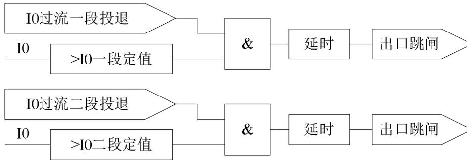
图 1.4 两段式零序 I0 过流保护逻辑
