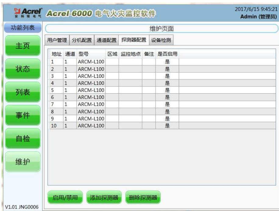
图 18 探测器配置界面
