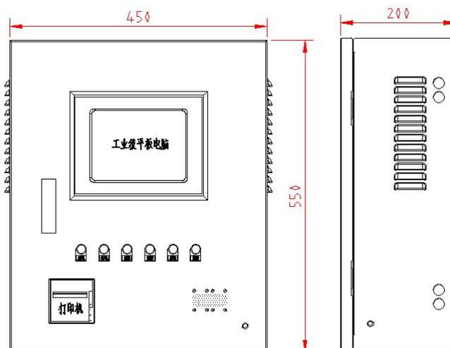
图 3 Acrel-6000/B1 电气火灾监控设备外形尺寸
